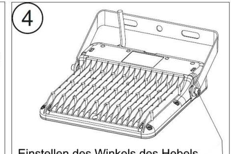
Einstellen des Winkels des Hebels und fixieren der Schrauben (Bügel + Bügelarretrierung).
