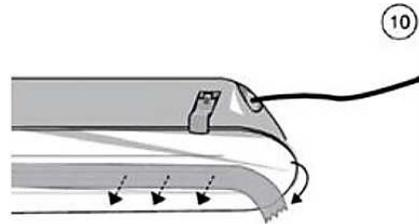
Abschließend die jeweils ersten und letzten beiden Kipphebel-Verschlüsse (siehe Pfeile in Abbildung unten) mittels der beiliegenden Torx-Schrauben sichern. Dazu die Schrauben in die vorgesehenen Öffnungen einschrauben.
