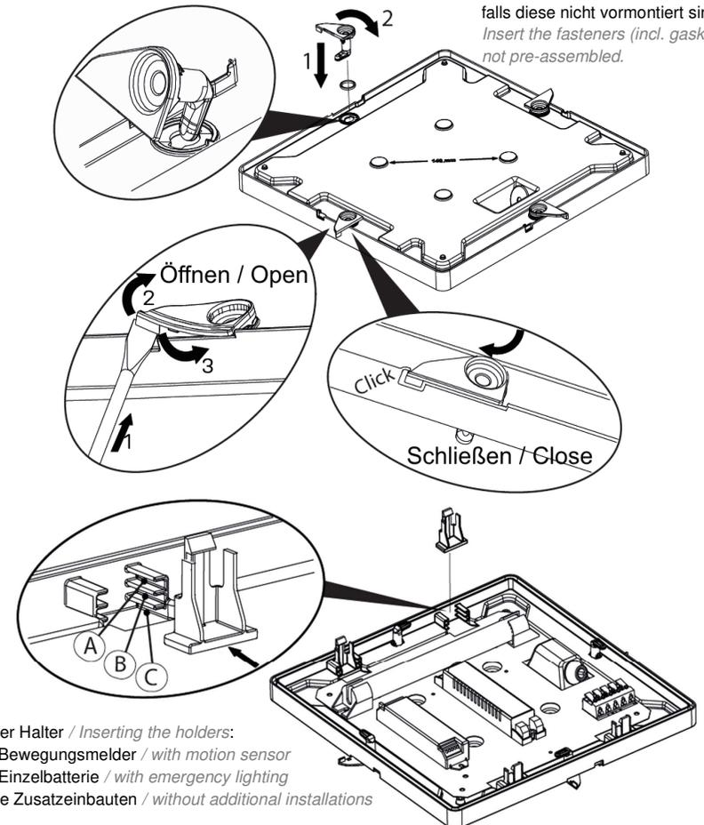
Einsetzen der Halter / Inserting the holders:
