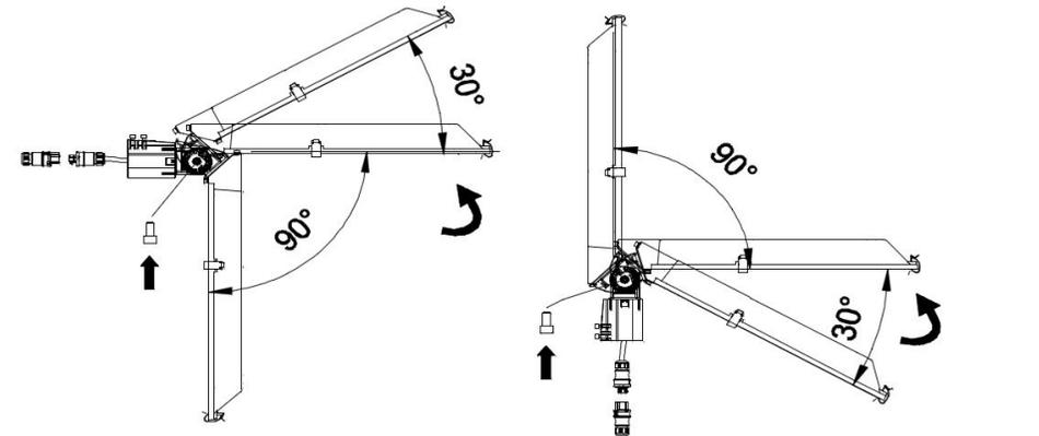
Bei Mast-Ø42mm optionalen Adapter verwenden.
