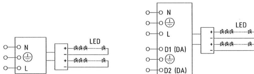
Bei Typen mit Dimmung (Zusatz 1-10V DIM bzw. DALI-DIM) ist die Steuerleitung zusätzlich anzuschließen:
